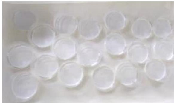
Figura 12. Muestras de Solid Surface SS4, espesor aproximado de 6-8 mm.
