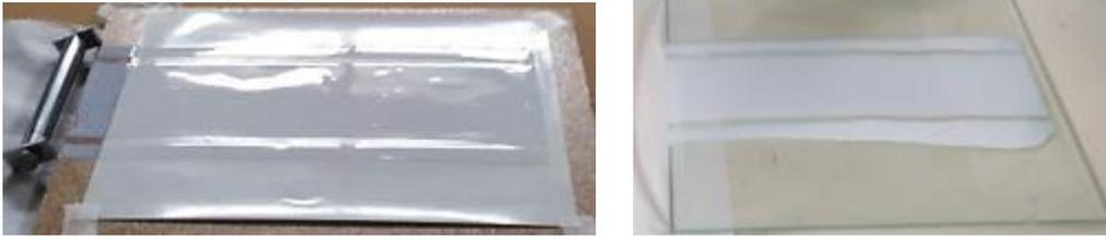
Figura 9. Extensión completa del recubrimiento sobre papel de teflón (izq.) y vidrio (dcha.) empleando el aplicador universal Baker.
