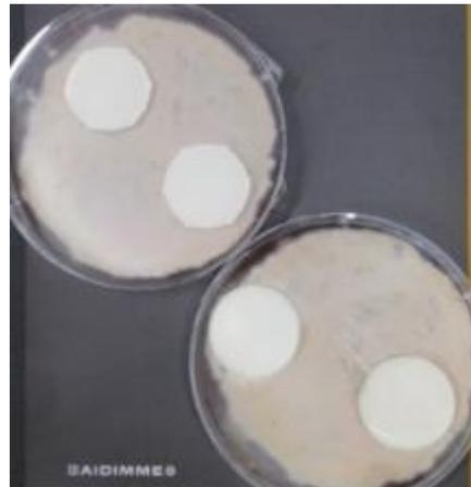
Figura 24. Probetas de envejecimiento con biocida despues de 4 semanas de incubación
