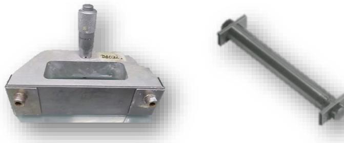
Figura 8. Multi-aplicador de 100 mm de ancho de hoja 0 – 1000  $\mu\text{m}$  (izq.). Aplicador Universal Baker, 0 a 250  $\mu\text{m}$ , ancho 50 mm (dcha.).
