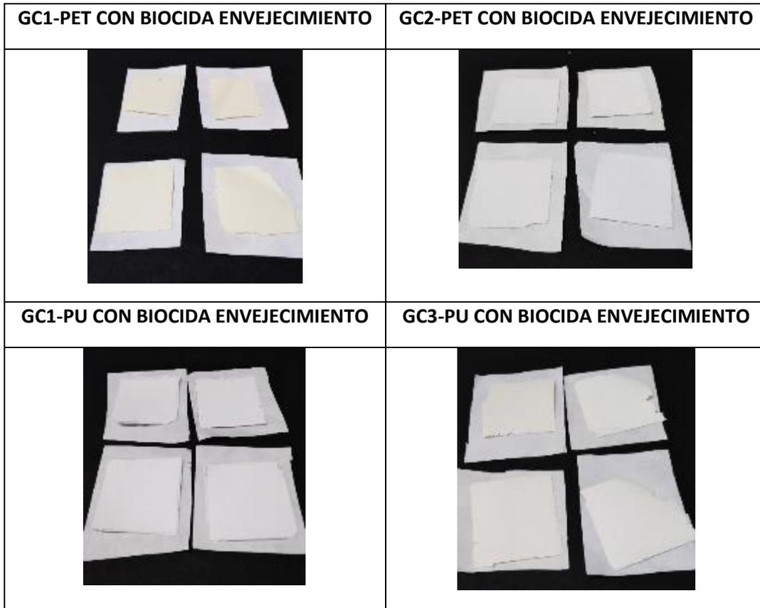
Figura 18. Muestras de Gel Coat tras los ciclos de envejecimiento
