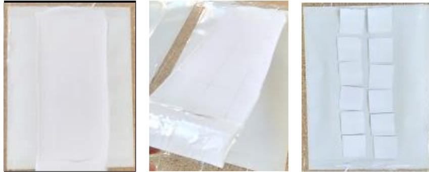
Figura 10. Aplicación acabado PU sobre lámina de teflón, despegue y corte.
